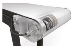
Hình 1. Lắp đặt con lăn điện
