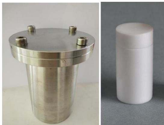
Hình 2. Bình Teflon (PTFE) dùng cho phản ứng thủy nhiệt
